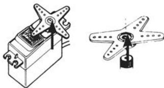
Lösen Sie die Befestigungsschraube des Servohebels und nehmen Sie den Zahnkranz vom Servo ab. Schalten Sie den Sender und danach den Empfänger ein. Stellen Sie das Steuerad und den Drehgeber der
