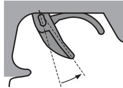
Bei Modellen mit Elektroantrieb, sollte die Neutralposition eingestellt werden. Dadurch kann das Modell im Fall einer Störung ausrollen.
