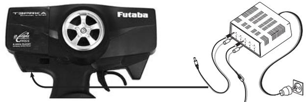
Die Akkuzellen können bequem, ohne sie auszubauen, geladen werden. Dazu befindet sich eine Ladebuchse auf der linken Seite des Senders unter der Frontabdeckung. Sender und Empfangsanlage zum Laden der Akkus ausschalten. Vor der Erstinbetriebnahme den Senderakku voll aufladen. **Beachten sie hierbei die Ladehinweise des Akkuherstellers.**
