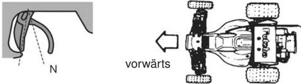
Durch Drücken des Gashebels nach vorn bewegt sich das Modell rückwärts (nur bei Elektroautos). Bei Autos mit Verbrennungsmotor ergibt die Hebefunktion nach vorne die Bremsfunktion.
