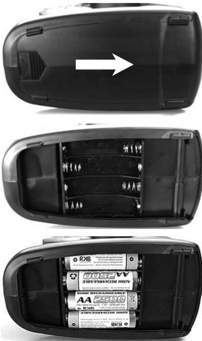
Die Megatech T3PRKA wird ohne Stromquellen ausgeliefert. Im Senderfuß befindet sich ein Batteriehalter für 4 Trockenbatterien (Mignonzellen 1,5 Volt) oder 4 NiMH-Akkuzellen. Wir empfehlen Ihnen die Verwendung von 4 Akkuzellen des Typs 2500 mAh für den Sender.
