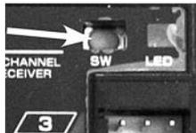
Durch Drücken der Taste "SW" wird im Empfänger automatisch die individuelle Codenummer des Senders gespeichert. Durch diese "Bindung" reagiert der Empfänger nur noch auf die Signale dieses Senders. Dadurch werden Störungen und der Einfluss von anderen Sendern sehr effektiv unterdrückt. Es können mehrere Empfänger an den gleichen Sender "angebunden" werden. Soll die "Bindung" an einen anderen Sender erfolgen so ist nach dem Einschalten die Taste SW erneut zu drücken.
