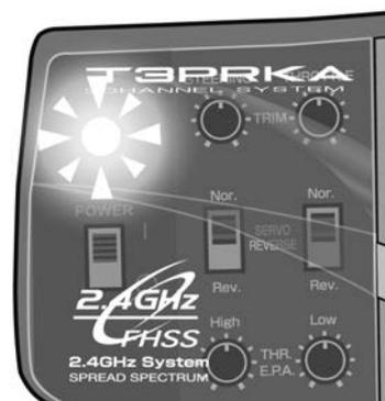
Sobald die Trockenbatterien / Akkus soweit entladen sind, dass die rote Monitor LED blinkt, ist der Fahrbetrieb sofort einzustellen. Die Trockenbatterien / Akkus müssen nun getauscht bzw. nachgeladen werden, bevor ein erneuter Fahrbetrieb stattfindet.
