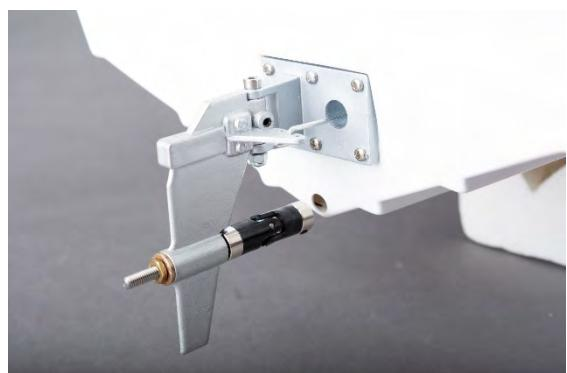
Abb. Z-Drive montiert
