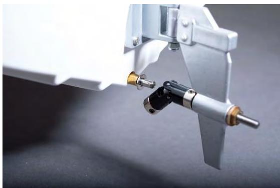
Abb. Stevenrohr platziert mit Unterlegscheibe
