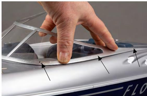
Abb. Befestigungspunkte der Scheibe
