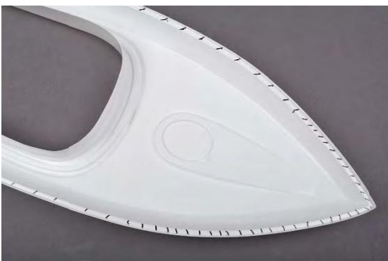
Abb. Klebefläche im Decksrand
