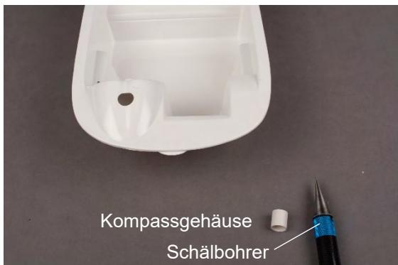
Abb. Bohrung für Kompassgehäuse
