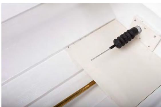
Abb. Faltenbalg aufgesetzt
