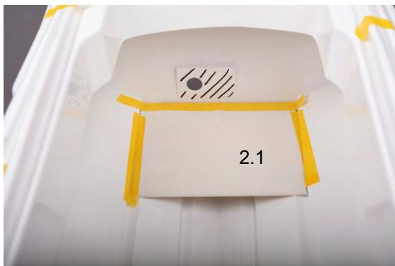
Abb. RC-Platte positionieren
