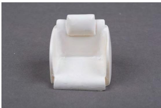
Abb. Sitzschale verschliffen und grundiert
