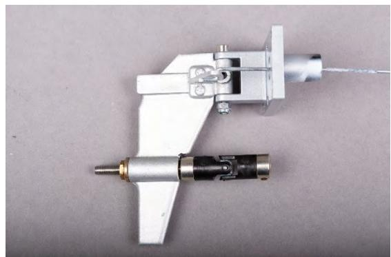
Abb. Ruderanlenkung montieren
