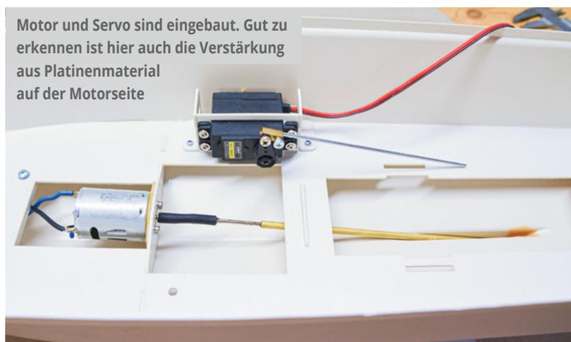
Motor und Servo sind eingebaut. Gut zu erkennen ist hier auch die Verstärkung aus Platinenmaterial auf der Motorseite
