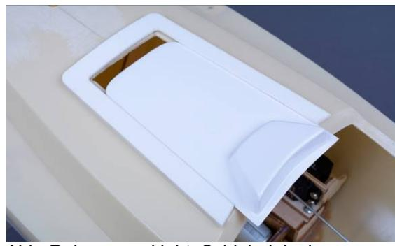
Abb. Rahmen verklebt, Schiebeluk einpassen
