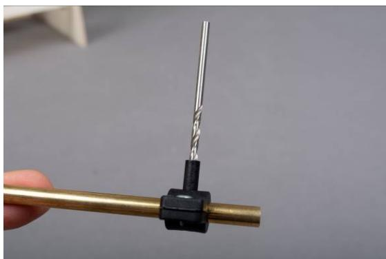
Abb. Schmierbohrung in Stevenrohr bohren
