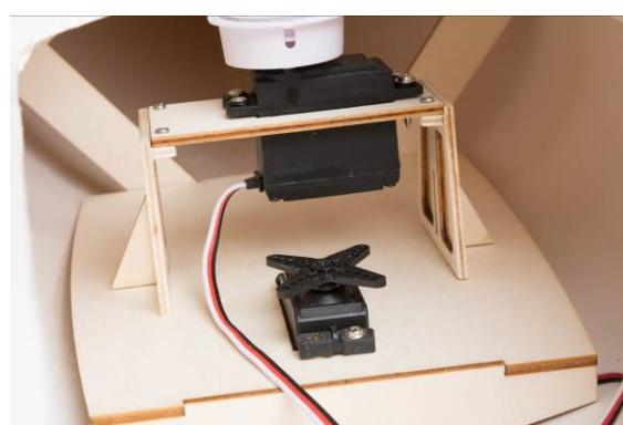
Montez le support de treuil sur la platine RC pour essai. Si tout est ajusté, traitez le support de treuil plusieurs fois au bouche-pores, puis collez-le sur la platine RC.
