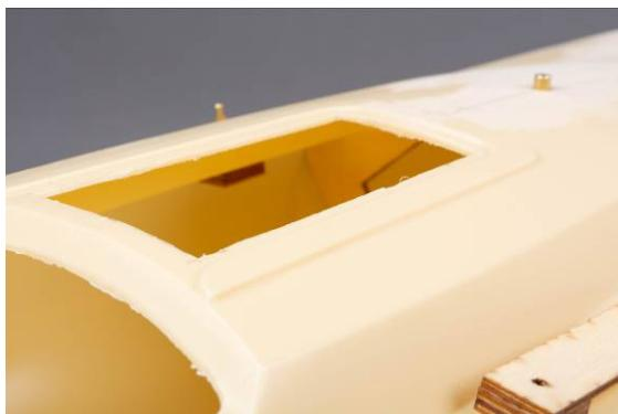
Wenn alles passt, den Spant mit Sekundenkleber an einigen Stellen fixieren. Danach den Spant mit Stabilit Express verkleben. Es ist darauf zu achten, dass in die seitlichen Taschen für die Verstärkungsbrettchen der Wanten kein Klebstoff gelangt.
