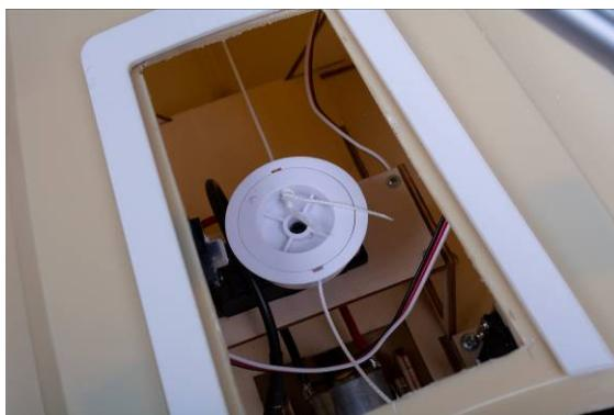
Abb. Segelwinde montiert
