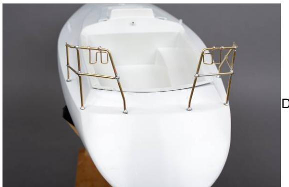
Vue: balcon arrière avec supports pour les bouées fer à cheval
