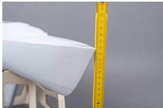
Abb. Bug ausrichten
