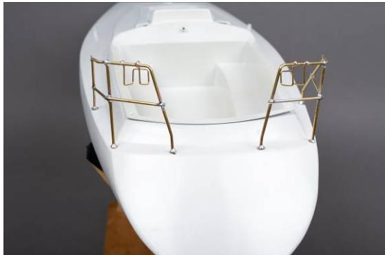
Abb. Heckkörbe mit Haltern für Rettungswesten
