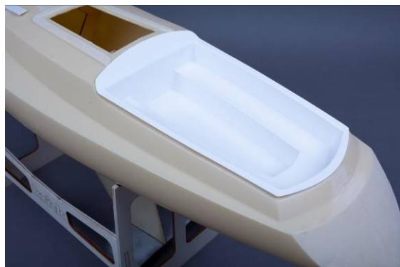
Abb. Plicht im Rumpf eingepasst
