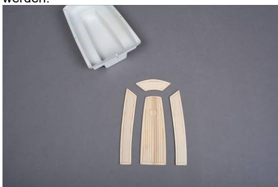
Abb. Plicht und Holzteile für Plicht
