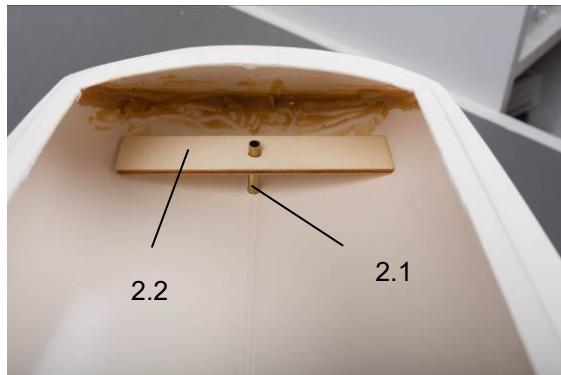
Enfilez le gouvernail par le bas et positionnez. Alignez le gouvernail de façon à ce qu'il soit exactement aligné avec la quille en regardant par l'arrière. En vue de côté, positionnez le gouvernail pour avoir un jeu constant avec la coque sur toute sa largeur. Le gouvernail doit pouvoir débattre librement dans les deux sens. Fixez le puits de gouvernail et le renfort avec de la colle cyanoacrylate.
