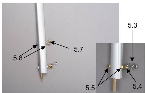
Abb. Befestigung Lümmelbeschlag und Niederholer
