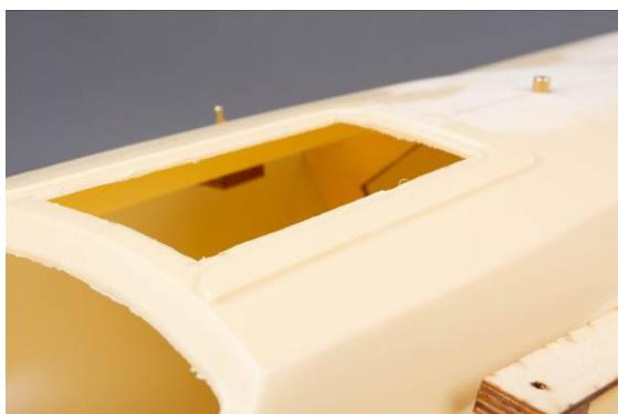
Lorsque tout est bien positionné, fixez le couple à plusieurs endroits avec de la colle cyanoacrylate. Collez alors le couple avec Stabilit Express. Veillez à ne pas mettre de colle dans les dégagements latéraux pour les renforts de fixation des haubans.
