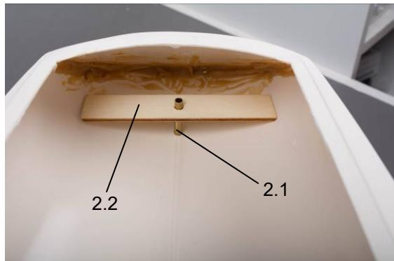
Von unten das Ruder einstecken und ausrichten. Das Ruder so ausrichten, dass es von hinten gesehen genau zum Kiel fluchtet. Von der Seite gesehen das Ruder so ausrichten, dass über die ganze Breite ein gleichmäßiger Abstand zum Rumpf eingehalten wird. Das Ruder muss in beide Drehrichtungen frei drehbar sein.
