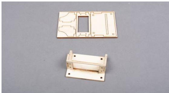
Abb. Laserbrett und fertige Servohalterung
