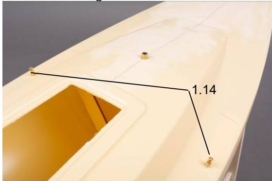
Jetzt die Verstärkungsbrettchen für die Wanten-Befestigung in die Taschen im Spant schieben und durch Eindrehen der Augenschrauben Teil 1.14 die Position prüfen.
