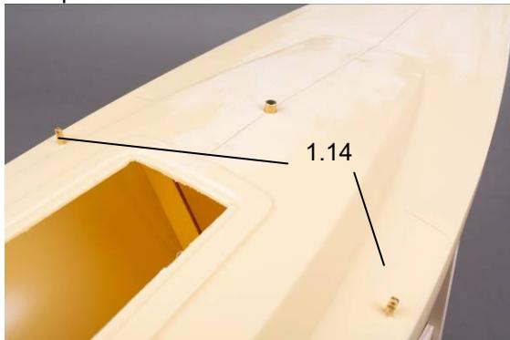
Montez alors les planchettes de renfort pour la fixation des haubans dans les dégagements du couple, et vérifiez leur position en vissant les vis à œillet 1.14.
