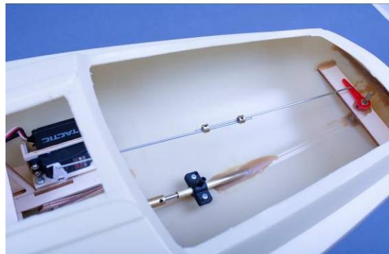
Abb. Verbindung Servo und Ruder
