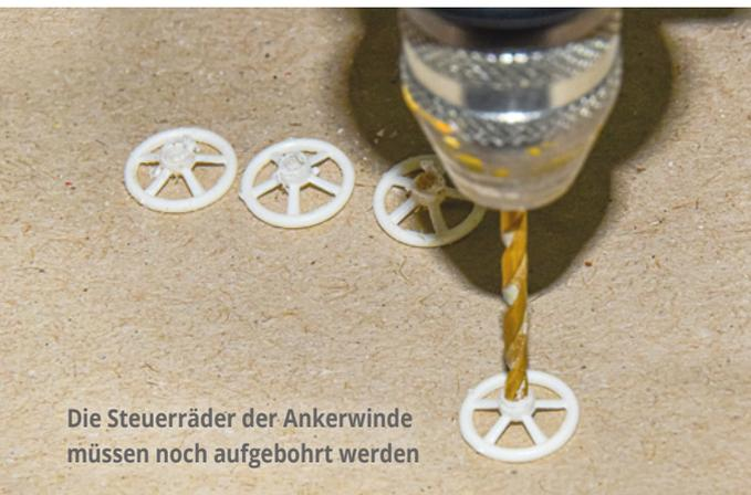
Die Steuerräder der Ankerwinde müssen noch aufgebohrt werden
