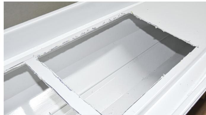
Hier wurde erst mit einer Trennscheibe vorgefräst und dann vollends durchgeschnitten. Die verschmolzenen Ränder können leicht abgebrochen werden
