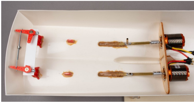
Abb.: Antrieb mit Brushl. Max Marine P365 Motoren
