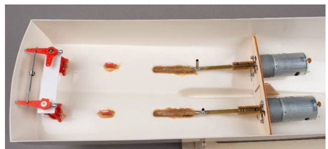
Abb.: Antrieb mit Max Gear Motoren
