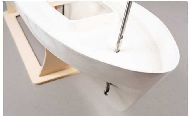
Abb.: Bohrung für Ankerfallrohr
