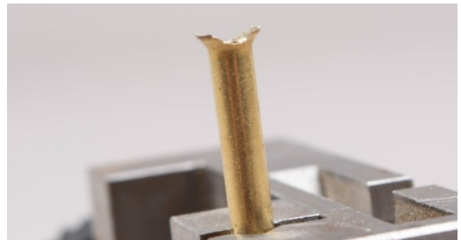
Abb.: Schmierröhrchen 3.3 rund feilen zum Anlöten
