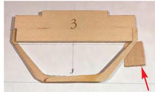
*Da natürlich gekrümmtes Holz nur noch schwer zu finden ist, werden bei modernen Booten stattdessen drei gerade Stücke für jeden Rahmen verwendet. Diese werden an den Winkeln durch verzinkte Stahlplatten oder Klammern auf jeder Seite der Verbindung verbunden, die durchgenietet werden. Alternativ werden Sperrholzwickel verwendet, die verleimt und dann genagelt oder genietet werden.*
