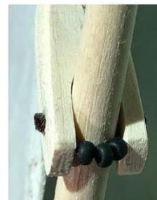
Wiederholen Sie die gleiche Reihenfolge, um den Baum am Mast zu befestigen. Es ist immer einfacher, so viel Takelage wie möglich außerhalb des Modells zu machen.
