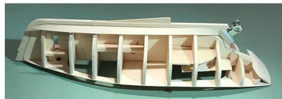
Kleben Sie den Rest des Brettes ein und achten Sie darauf, dass es nicht in den Teil des Falzes geklebt wird, in dem das Mittelbrett sitzt. Vergewissern Sie sich, dass die Kante der Planke über die gesamte Länge fest im Falz sitzt. Wenn Sie das Brett richtig geformt haben, brauchen Sie nur sehr wenig Klemmen oder Klammern, während der Leim aushärtet (Foto unten). Wiederholen Sie diesen Vorgang auf der anderen Seite des Rumpfes.
