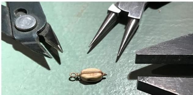
Fädeln Sie die Schlaufe dieses Blocks auf die Reisestange und drücken Sie die Stange in die Löcher am Heck des Modells. Verwenden Sie zur Sicherung eine kleine Menge Sekundenkleber oder Epoxidharz.
