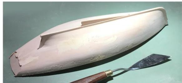
Wenn möglich, verwenden Sie eine Lichtquelle, die schlechte Stellen sichtbar macht. Ich habe LePage's 'Natural' Holzspachtel aus der Tube verwendet. Tragen Sie die Spachtelmasse mit einem Spachtel auf und lassen Sie sie vor dem Schleifen ausreichend trocknen.
