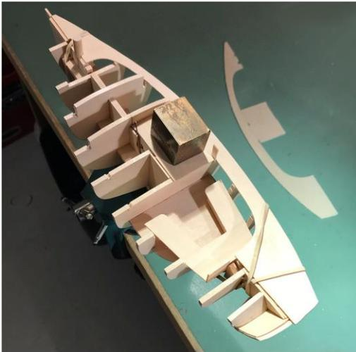
Befeuchten Sie die Oberseite der einen Hälfte des Decks, um es geschmeidiger zu machen. Es wird sich ein wenig wellen, was normal ist. Halten Sie einige Gummibänder bereit. Streichen Sie Weißleim auf die Oberseiten der Rahmen und des Rückens, legen Sie das Deck auf und positionieren Sie es. Benutzen Sie die Gummibänder und kleine Gewichte, um das Deck zu halten, während der Kleber aushärtet. Achten Sie darauf, dass der Maststummel oder die Schwertstange (falls vorhanden) nicht eingeklebt werden!
