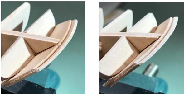
Die Oberseite des Querbalkens (oben links) muss nun plan geschliffen werden. Verwenden Sie die beiden hinteren Spantenoberseiten als Führung und
