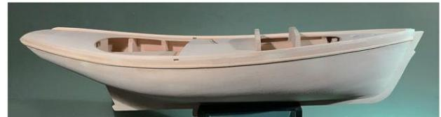
Am Heck wird das Ende der Schiene abgerundet, wie rechts dargestellt. Entlang der Naht kann etwas Spachtelmasse erforderlich sein. Prüfen Sie die Naht sorgfältig mit dem Licht und bessern Sie eventuelle weitere Mängel aus.
