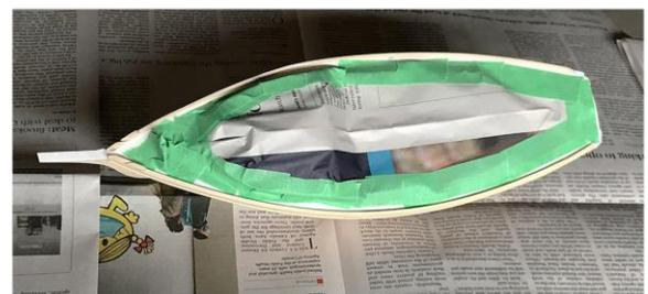
Wenn Sie Farbe auf Wasserbasis verwenden, sprühen Sie den Rumpf zunächst mit einer Grundierung aus einer Klapperkiste ein. Dadurch wird die aufgeworfene Maserung verhindert, die bei Feuchtigkeit auf Basswood entsteht. Alternativ können Sie die Maserung nach dem ersten Anstrich mit Schleifpapier der Körnung 240 abschleifen.
