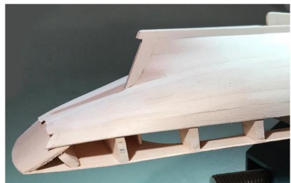
An den Spanten 3, 6 und 9 befinden sich kleine Markierungen, an denen Sie erkennen können, ob Ihre Beplankung aus der Reihe tanzt. Wenn dies der Fall ist, können Sie die nachfolgenden Beplankungen so anpassen, dass die Scherbalken an der richtigen Stelle enden.
