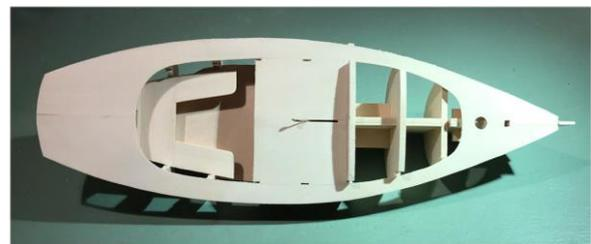
Das Deck sollte in diesem Stadium wie auf dem Foto oben aussehen. Wenn ein Bereich nicht fest verklebt ist, befeuchten Sie die Stelle und drücken Sie sie an, wenn sie gut getrocknet ist, schleifen Sie sie glatt. Die vordere Kante des Cockpits muss bündig zum Spant geschliffen und die Kante abgerundet werden.
