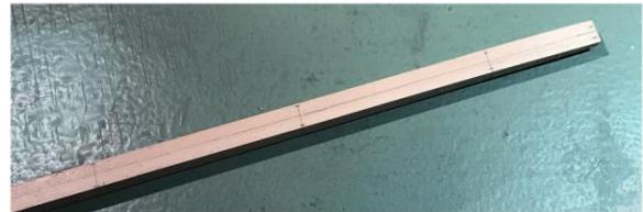
Als Nächstes zeichnen Sie den Holm an, um ihn in ein Achteck zu schneiden. Verwenden Sie dazu den Maßstab 7:10:7. Diese Proportion wird für den Zuschnitt eines Achtecks verwendet, das der nächste Schritt bei der Umwandlung eines quadratischen Holzstücks in ein rundes ist.
