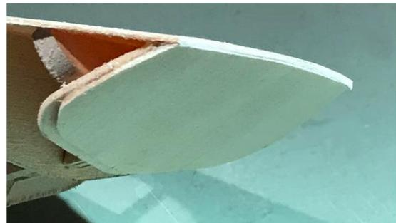
Schleifen Sie nun den Decksüberstand vertikal am Heckspiegel wie gezeigt. Die Kante sollte über die gesamte Oberseite des Heckspiegels eine gleichmäßige Breite aufweisen. Ihr Modell nimmt nun langsam Gestalt an. Aber es gibt noch viel zu tun!
