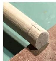
flachen Sägeschnitt und schneiden Sie eine weitere Abflachung. Diese sollte parallel zur ersten Fläche verlaufen. Feilen Sie den Abstand zwischen den Abflachungen so ab, dass er in den Schlitz des Sockels passt.
