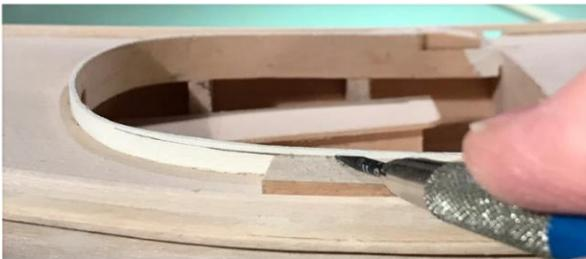
An dieser Stelle kleben Sie den Samsonpfosten ein. Achten Sie darauf, dass er von vorne gesehen senkrecht steht. Er wird in seiner Fassung nach vorne geneigt erscheinen. Dies wird richtig aussehen, wenn das Modell montiert ist, da es mit dem Heck nach unten schwimmt.
