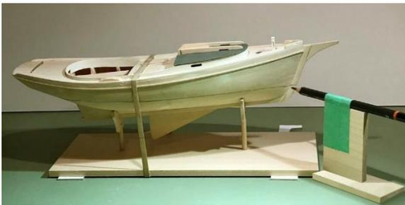
*Optionales Detail:* Oft wird die Farbe an der Wasserlinie am Bug und am Heck leicht angehoben, um eine optische Täuschung zu verhindern. Sie können die Linie der Maskierung anpassen, um dies zu zeigen, wenn Sie möchten.
