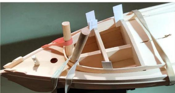
Schneiden Sie die hinteren Enden so zu, dass sie an den Süllrand stoßen. Falls sich an der Nahtstelle leichte Lücken ergeben, können diese später gefüllt werden. Entfernen Sie das Teil und lackieren Sie den oberen Teil wie zuvor. Vergessen Sie nicht, auch die Kanten der Kabinenbeleuchtung (Fenster) zu streichen. Schleifen Sie die erste Schicht nach dem Trocknen mit Korn 240 ab und streichen Sie sie erneut.
