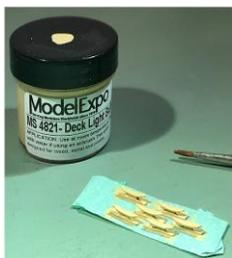
Klampen entweder mit CA oder Epoxy. Ich bevorzuge Epoxidharz, da es Zeit gibt, die Klampe zu positionieren. Biegen Sie die Basis der Klampe oberhalb der Pinne (das Metall ist weich), um sie an die Kurve des Cockpits anzupassen, bevor Sie sie mit dem vertikal in den Schraubstock eingespannten Modell einkleben.
