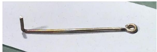
Verwenden Sie die Zange, um den Draht bei Bedarf zu glätten. Verwenden Sie feines nasses und trockenes Karborundpapier, um die fertige Metallarbeit zu glätten. Damit ist die Zugstange für das Schwert fertig.
