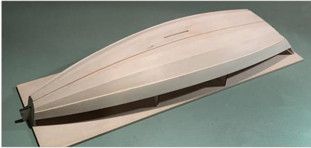
Eventuelle kleine Vertiefungen in den Planken oder Lücken an Bug und Heck - und es wird einige geben! - können mit ein wenig Karosseriespachtel, der gut abgeschliffen wird, ausgeglichen werden. Dies wird später durch Farbe verdeckt. Ihre Beplankung ist nun fertig.
