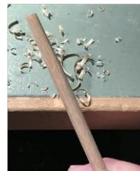
Sie noch nicht fertig! Die Hauptlänge des Holms muss ebenfalls im Durchmesser reduziert werden. Verwende auch hier Schleifpapier. Wenn die grobe Formgebung abgeschlossen ist, verfeinern Sie sie mit 150er-Schleifpapier, bis sie der Zeichnung auf Seite 5 entspricht. Nichts sieht an einem Modell schlimmer aus als "fette" oder übergroße Masten und Holme.
