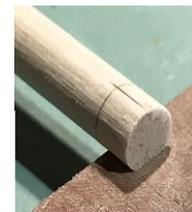
Wiederholen Sie diesen Vorgang mit dem längeren Dübel, aber machen Sie diesmal die Abflachungen 3/16" lang. Sobald die Querstücke gut auf die Pfosten passen, kleben Sie sie zusammen.
