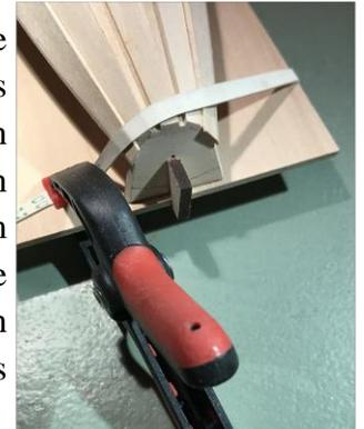
Sie dann den Riegel aus seinem Schlitz. Es ist erstaunlich, wie steif die Schale an dieser Stelle ist. Wenn Sie sich vergewissert haben, dass die Verbindungen fest sitzen, setzen Sie das Modell wieder auf das Brett. Vergewissern Sie sich, dass der Rumpf ganz unten auf den Formen liegt (Foto unten).
