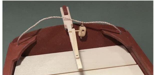
Alternativ können Sie auch das unten beschriebene optionale Verfahren anwenden. Hängen Sie den Clip an das Bugstagband. Legen Sie den Mast an seinen Platz und führen Sie die Leine nach oben, um die hintere Seite des Mastes herum und über die Klampe. Markieren Sie die Stelle, an der die Leine die
