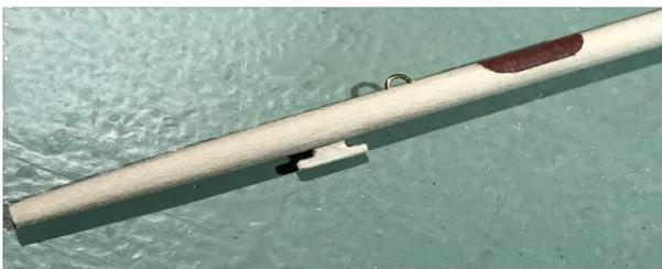
An der Spitze des Mastes befinden sich weitere Beschläge. Der erste ist die Klampe für das Vorstag. Sie verhindert, dass das Stag herunterrutscht. Markieren Sie die Stelle, an der sie befestigt ist, auf dem Plan auf Seite 5. Nehmen Sie die Klampe von der Schot ab, säubern Sie sie und schleifen Sie die
