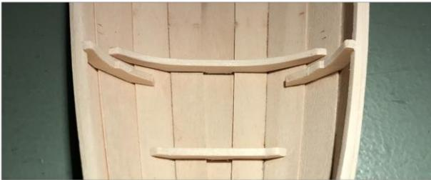
Wiederholen Sie diesen Vorgang für die Sitzrahmen B, C, D und E. Die Rahmen C und D mittschiffs sollten nach dem Einbau nicht abgeschragt werden müssen.
