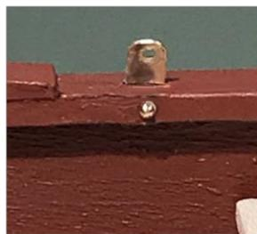
zu lang ist, schneiden Sie ihn vorher kurz ab. Ein Klecks Cyanacrylat-Kleber sorgt dafür, dass sich der Bolzen nicht löst. Setzen Sie die Platte ein und treiben Sie den Bolzen durch die Rinne und die Platte. Er sollte sich ein wenig in die dahinter liegende Planke "verbeißen".
