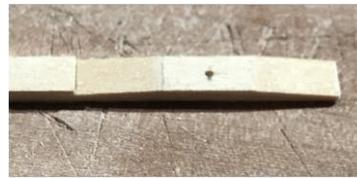
Jedes Pad sollte in der Mitte für ein Loch markiert werden. Bohren Sie mit einem #55-Bohrer. Ein nützliches
