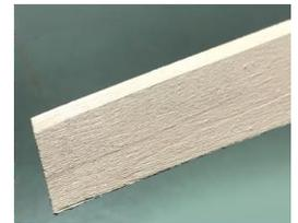
Biegen Sie diese beiden Bretter wie die Kielplanke und lassen Sie sie über Nacht trocknen, dann schleifen Sie die erhabene Maserung auf beiden Seiten der Bretter ab.
