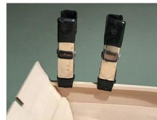
würde es zunächst auf Höhe der Bugseite des Querträgers zuschneiden. Der Winkel muss von oben gesehen ungefähr stimmen. Dann schleifen Sie das Ende allmählich ab, bis es gut sitzt, wenn der Rest des Schandeckel auf gleicher Höhe mit der Schur ist. Wenn die Passform im Inneren des Riegels nicht perfekt ist, machen Sie sich keine Sorgen. Das wird bald verdeckt sein.
