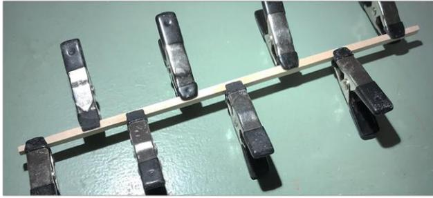
Während das Ganze trocknet, bauen Sie die Holmschablone so zusammen, dass sie wie auf dem Foto unten aussieht. Der Bankhaken kommt auf die Unterseite, die dem Endstück gegenüber liegt.
