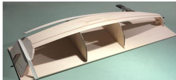
Wenn der Kleber ausgehärtet ist, kleben Sie die "Naht" zwischen den Planken an die zweite Form und dann weiter an den Heckspiegel. Prüfen Sie, ob die Planke an beiden Formen anliegt und der Rumpf sich nicht zu spreizen beginnt.
