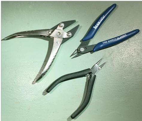
Scheren für weiches Metall funktionieren nicht bei hartem Messing. Sie werden einfach die Schneiden beschädigen. Ich verwende die von BeadSmith. Die Xuron 9200 könnte eine Alternative sein.
