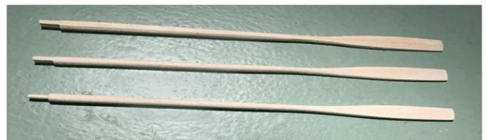
Spannen Sie das Rudern ein, während Sie es formen. Machen Sie dies abschnittsweise, damit nicht zu viel Länge aus dem Schraubstock herausragt. Drehen Sie es um eine Vierteldrehung, damit die Abrundung auf allen Seiten gleichmäßig ist. Verwenden Sie einen
