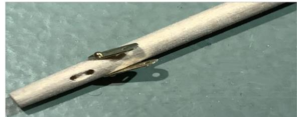
Die letzten Teile sind ein Paar Riemen für die hinteren Streben. Nehmen Sie sie vorsichtig aus dem Fotoätzteil heraus. Sie sind mit Messingbolzen am Mastkopf befestigt. Schneiden Sie die Bolzen recht kurz, damit einer den anderen nicht herausdrückt, und befestigen Sie sie mit einem Klecks Sekundenkleber zur Sicherung. Damit sind die Arbeiten am Mast abgeschlossen.
