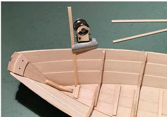
Diese Stücke sind überlang, damit sie leichter zu handhaben sind. Befeuchten Sie die Innenseite und kleben Sie die Außenseite. Befestigen Sie das untere Ende zwischen der Ecke der unteren Klampe und der Seite und klemmen Sie es dann wie gezeigt an der Außenhaut fest. Schneiden Sie die Überlänge nach dem Trocknen ab und schleifen Sie sie bündig zur Schot.
