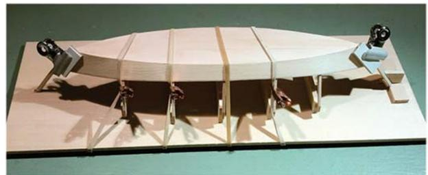
Bringen Sie eine Mischung aus Leim und Wasser in alle offenen Stellen entlang der Bodenfuge ein und schließen Sie sie mit Gummibändern. Entfernen Sie überschüssigen Leim, bevor er aushärtet.
