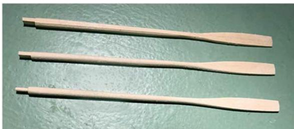
Ein kleiner Schraubstock (siehe Blatt "Werkzeuge und Materialien") hält das Ruder während der Formgebung fest. Machen Sie dies abschnittsweise, damit es nicht zu weit aus dem Schraubstock herausragt. Drehen Sie es um eine Vierteldrehung, damit die Abrundung auf allen Seiten gleichmäßig ist. Wenn sich das Ruder zu biegen beginnt, besteht die Gefahr, dass es reißt. Nehmen Sie einen kleinen
