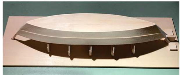
Das fertige Brett wird an beiden Enden beschnitten und die Außenfläche leicht angeschliffen. Sie sollte nun wie auf dem Foto oben aussehen. Beachten Sie die verschwindende Überlappung an beiden Enden. Wiederholen Sie den Vorgang auf der zweiten Seite.
