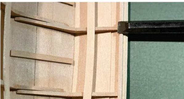
Sie können diese Bänder auf der Innenseite der Rahmen durch Pappstreifen darstellen, die in einer Breite von 3" und einer Länge von 4" geschnitten werden. Sie müssen nicht aus Metall sein! Benutzen
