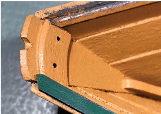
Mit einer kleinen Schere ist das kein Problem. Wenn Sie die Schiene etwas zu kurz geschnitten haben, lässt sich das leicht beheben. Verwenden Sie ein wenig Karosseriespachtel. Lassen Sie diesen gut trocknen, schleifen Sie ihn ab und lackieren Sie ihn. Wiederholen Sie den Vorgang auf der zweiten Seite und versuchen Sie, die Fuge am Bug zu treffen (unten). Auch hier kann jeder Spalt mit ein wenig Spachtelmasse und Farbe ausgebessert werden.
