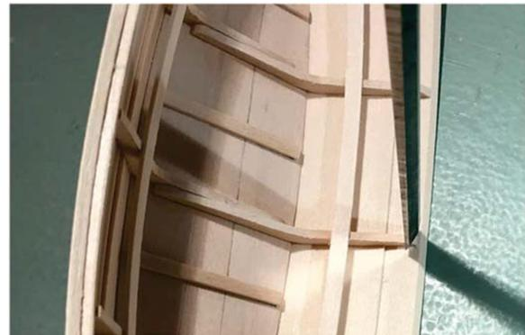
Der Schandeckel wird aus 1/16" Basswood-Streifen hergestellt, die dem Bausatz beiliegen. Der Schandeckel muss an beiden Enden sorgfältig eingepasst werden. Dieser Schritt ist ein wenig knifflig. Beginnen Sie am vorderen Ende. Schneiden Sie zuerst den Winkel am Bug, wie von oben gesehen. Damit er gut am Vorbau anliegt, muss dieses Ende nun hinterschnitten werden. Verwenden Sie dazu das Stemmeisen. Wiederholtes Anbieten und Anprobieren führt hier zum Erfolg.
