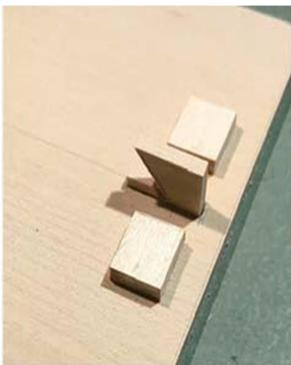
Sobald die Fasen fertig sind, kann der Boden angebracht werden. Beachten Sie die Schlitz im Brett für den Vorbau und die Riegelhalterung. Drücken Sie den Riegelhalter aus, säubern Sie ihn und schieben Sie ihn in den Schlitz, **aber kleben Sie ihn nicht ein.**
