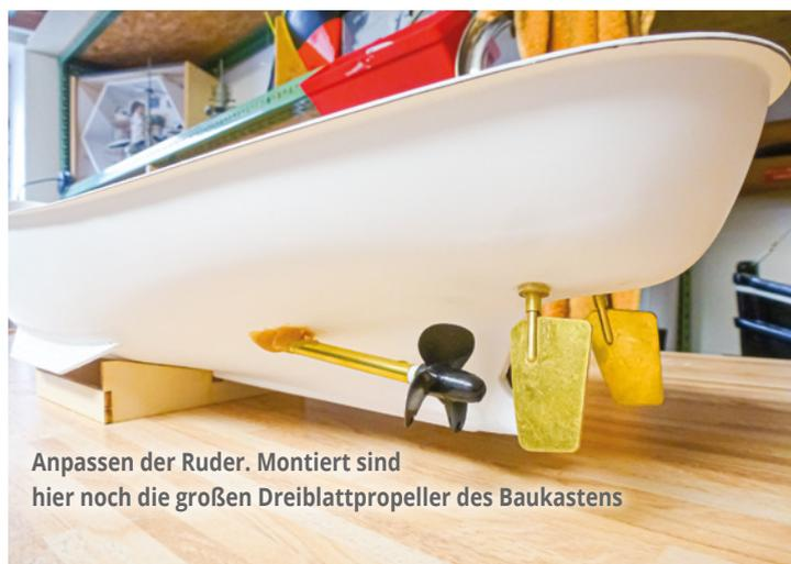
Anpassen der Ruder. Montiert sind hier noch die großen Dreiblattpropeller des Baukastens
