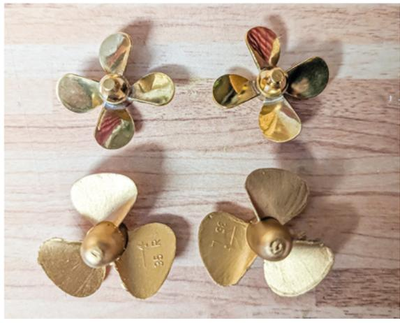
Größenvergleich der lackierten Bausatzpropeller (unten) und der ersatzweise beschafften 4-Blatt-Messingpropeller
