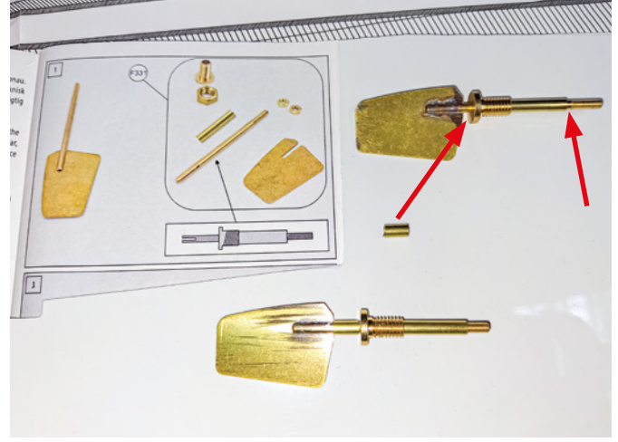
Abb. 7: Diese beiden Rohrstückchen müssen verwendet werden, die Anleitung gibt dazu jedoch keinen Hinweis
