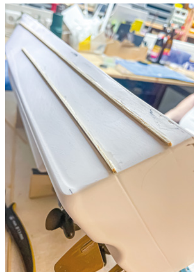
Abb. 20: Positionieren und Verkleben der Fendergummischienen
