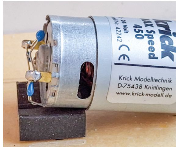
▶ Abb. 15: Gummipuffer stützen die freihängenden Motoren am Montagebrett ab
