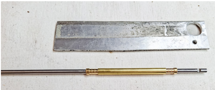
▲ ▼ Abb. 8: Die Teile für das Stevenrohr haben wir auf einen 4-mm-Stahl aufgefädelt, diesen rechtwinklig im Schraubstock mithilfe einer Auflage (oben im Bild) eingespannt und mit dem Hammer zusammengeklopft. Ergebnis ist ein gut fluchtendes Stevenrohr
