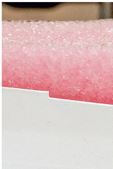
Abb. 19: Eine Stufe, die keine ist. Die Markierung im Rumpf ist keine Schnittlinie, sondern eine Positionierungshilfe für die Auflageleiste des Decks im Bugbereich, wie wir zu spät feststellten
