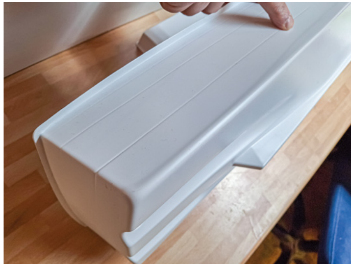
Abb. 3: Tiefziehfehler im Rumpf. Die Schönheitsfehler befinden sich aber im Unterwasserbereich
