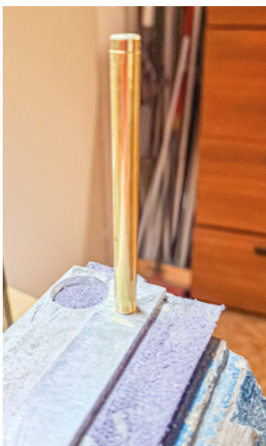
▲ ▼ Abb. 8: Die Teile für das Stevenrohr haben wir auf einen 4-mm-Stahl aufgefädelt, diesen rechtwinklig im Schraubstock mithilfe einer Auflage (oben im Bild) eingespannt und mit dem Hammer zusammengeklopft. Ergebnis ist ein gut fluchtendes Stevenrohr
