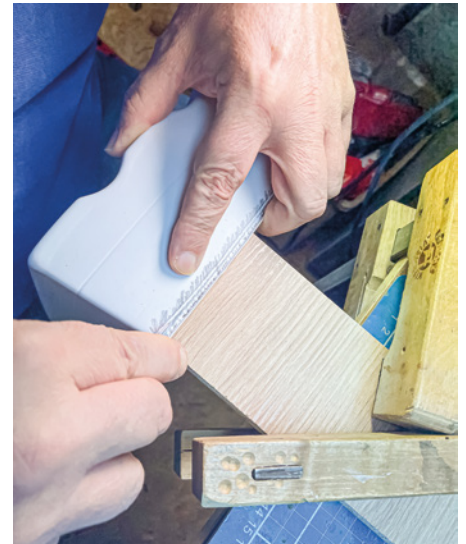
Abb. 11: Ein an die Werkbank gespanntes Holz dient als Auflage beim Anritzen der Markierungen
