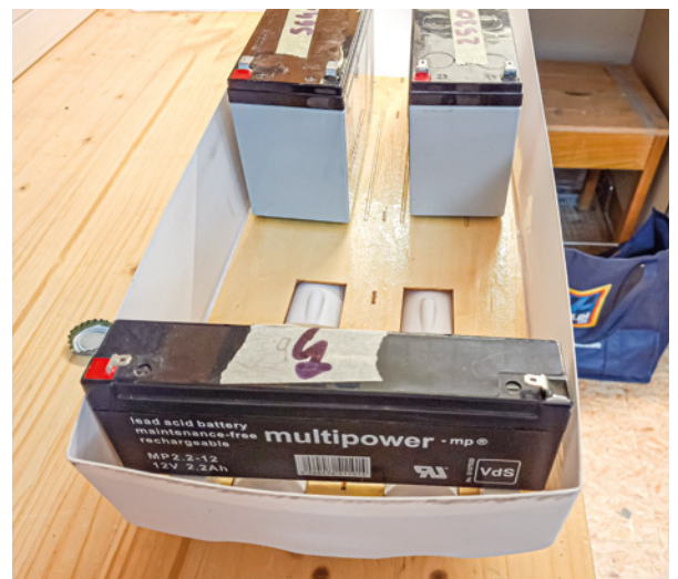
Abb. 13: Einkleben des Technikbretts. Die Oberseite wurde ebenfalls mit Harz bestrichen. Die Gewichte stehen auf Stützen
