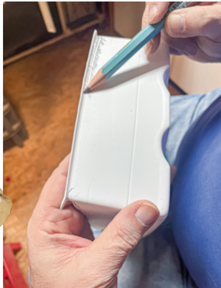
Abb. 10: Ein Bleistift macht die Schnittmarkierungen am Rumpf sichtbar
