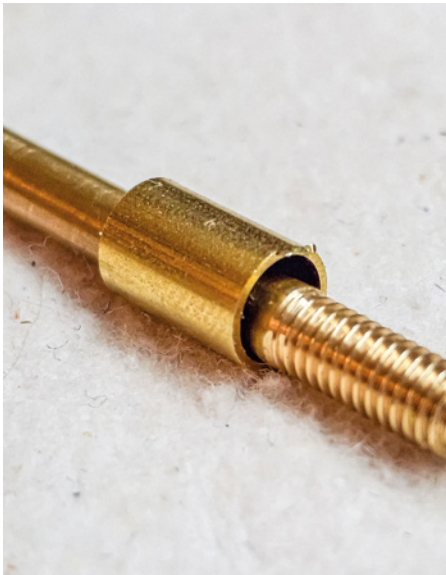
Abb. 9: Dieses 6-mm-MS-Rohr soll als Lager für die Wellenabstützung verwendet werden
