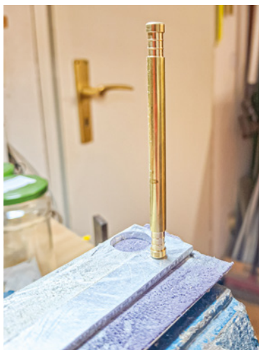
▲ ▼ Abb. 8: Die Teile für das Stevenrohr haben wir auf einen 4-mm-Stahl aufgefädelt, diesen rechtwinklig im Schraubstock mithilfe einer Auflage (oben im Bild) eingespannt und mit dem Hammer zusammengeklopft. Ergebnis ist ein gut fluchtendes Stevenrohr
