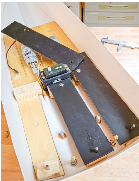
Abb. 18: Auf diesen Montagebrettchen finden später die Elektronik-Baugruppen Platz
