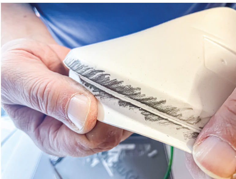
Abb. 12: Nach dem Anritzen wird das ABS-Material einfach weggeknickt
