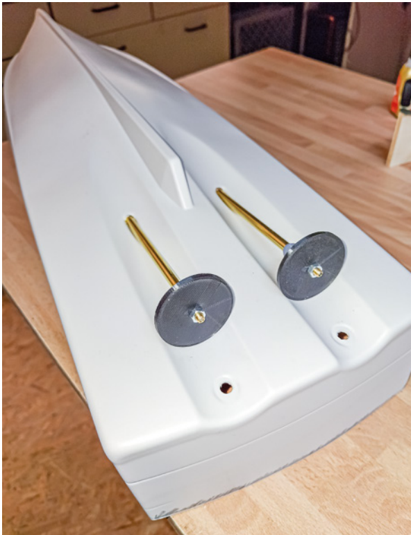
◀ Abb. 14: Selbst erstellte Ab- standsscheiben hel- fen beim exakten Ausrichten und Ein- kleben der Wellen- anlage
