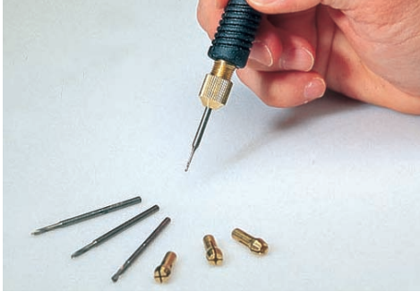
Bohren mit Bohrereinsätzen für 0 - 3 mm Bohrer
