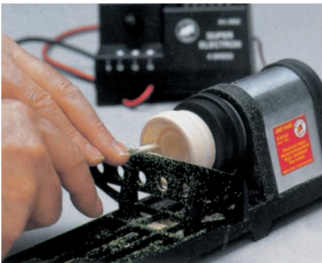
Innenausdrehen mit Stichling und Auflagebock.
