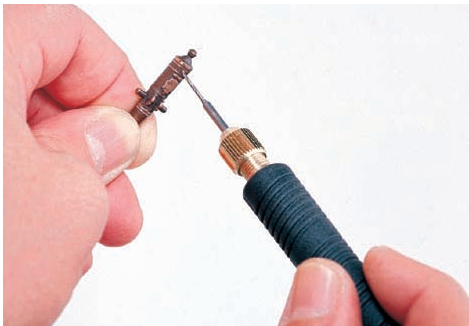
Bohren mit Bohrereinsätzen für 0 - 3 mm Bohrer
