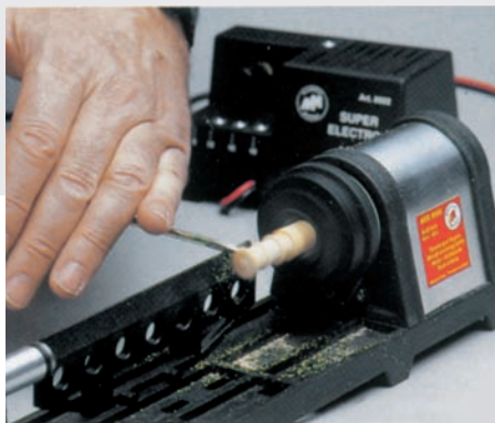
Dreheln einer Außenkontur mit Stechbeitel.
