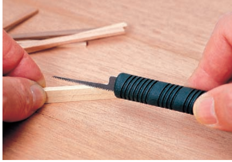
Sägen mit 10 mm Sägeklingen
