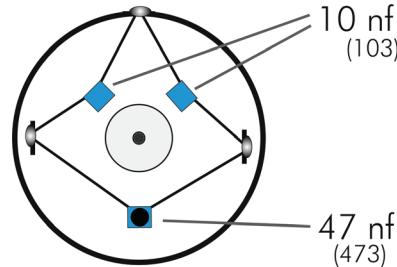
**Remarque :** le kit antiparasite minimise les perturbations du moteur électrique sur le régulateur et le système de réception RC. Il doit être utilisé pour toutes les applications.
