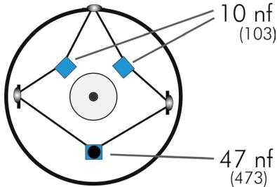
**Hinweis:** Der Entstörsatz minimiert die Störungen des Elektromotors auf den Regler und die RC-Empfangsanlage. Er sollte bei allen Anwendungen eingesetzt werden.
