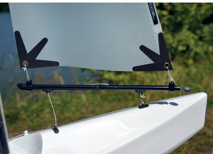
Detailaufnahme des Vorschot-Baums. Er ist aus einem GFK-Rohr und hat ein trimmbares Ausgleichsgewicht
