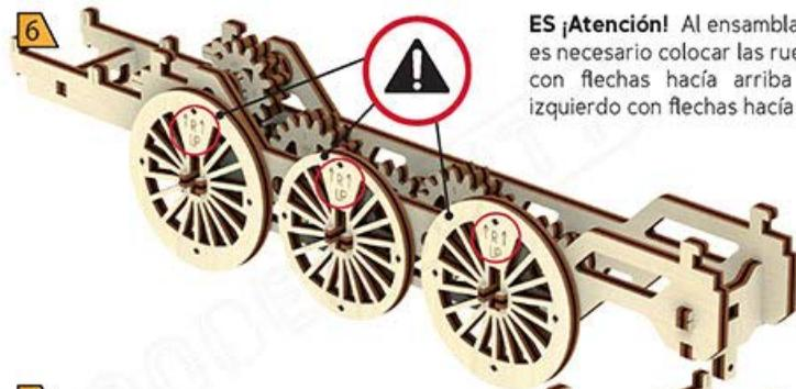
**ES ¡Atención!** Al ensamblar los pares de ruedas es necesario colocar las ruedas del lado derecho con flechas hacia arriba y ruedas del lado izquierdo con flechas hacia abajo.
