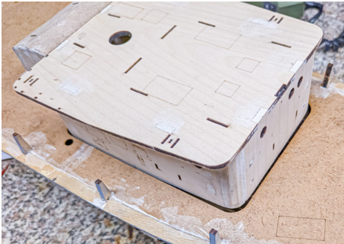
Besagter Spalt im gelieferten Deck zu meinen gebauten Aufbauten
