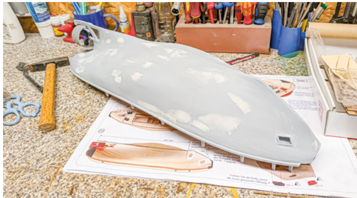
Fertig gespachtelt und gefillert. Der Rumpf ist super glatt und kann lackiert werden
