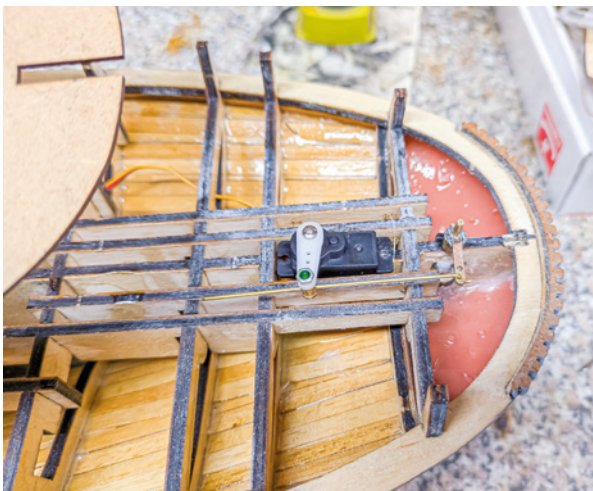
Die Anlenkung im Heck. Das Gestänge und das Ruderhorn muss man selbst bauen
