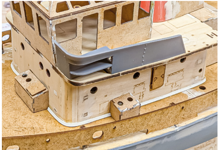
Umlaufendes PS-Profil, um den Spalt im Deck abzudecken. Erneute Stellprobe, ob nun alles passt
