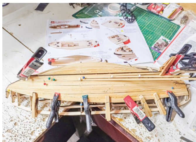
Es wird immer je eine Leiste rechts und dann links geplankt. Sonst könnte sich das Spantgerüst verziehen
