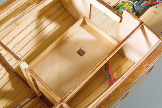
Als Akku habe ich einen 3s-LiPo vorgesehen, der hier im Kabinenbereich zum Liegen kommt
