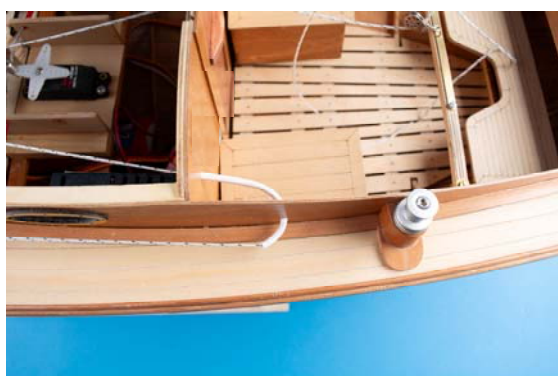
Abb.: Schotführung eingebaut
