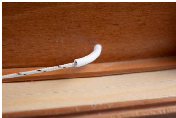
Abb.: Schotdurchführung Bordwand außen
