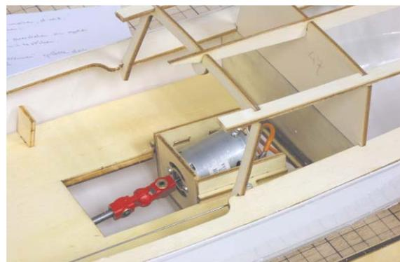
Der Dachträger 49 wird nun mit den Kabinenspannten verklebt. Die Kabinenvorderwand 50 wird vor dem Anleimen passend zugeschliffen und ebenfalls verklebt. Danach die seitlichen Dachträger 51 anpassen und ebenfalls anleimen.
