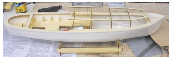
Der Kabinenspant 47 wird, falls notwendig, so zurechtgeschliffen, dass zwischen dem Kabinenspant 47 und der Kabinenrückwand 43 noch ein kleiner Spalt vorhanden ist da der Lack noch etwas aufträgt.
