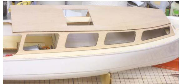
Als nächstes werden die Bohrungen für die Relingstützen 54 angebracht. Danach erst wird der Kabinenaufbau fertig verschliffen und lackiert.
