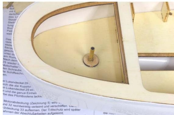
Der vordere Lukendeckel 42 und das Bugschanzkleid werden gemäß der Zeichnung im Bauplan zurechtgeschliffen. Dann wird die Kabinenrückwand 43 eingepasst und lackiert, aber noch nicht mit dem Rumpf und Pflichtboden verkleimt. Nun den Stahldraht für die Antenne 44 einschieben.
