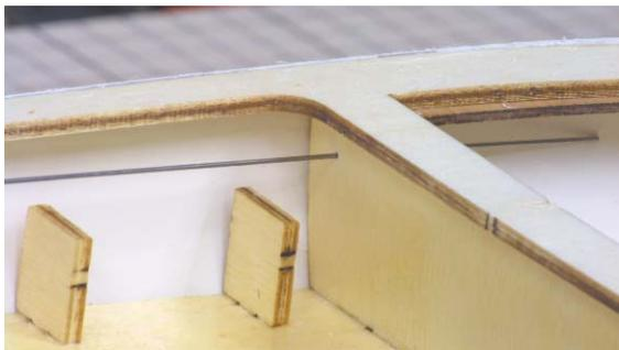
Dann wird der hintere Lukendeckel eingepasst und plangeschliffen.
