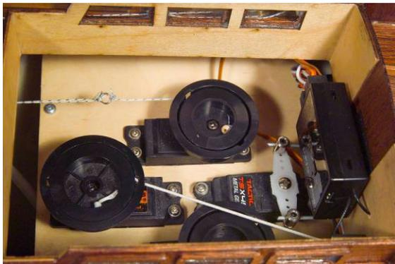
Fädeln Sie die Schotleine Pos. 170-1 durch die Decksdurchführungen bis zum Servobrett und befestigen Sie die Schoten an dem Ring.
