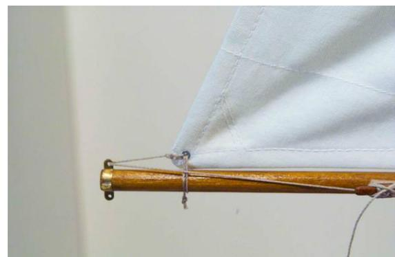
Am Schothorn das Segel nach unten um den Großbaum binden und eine Leine vom Schothorn durch den Nockbeschlag des Baumes führen und an einer Klampe belegen. Dadurch kann die Spannung des Unterlieks eingestellt werden.
