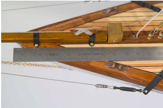
Bringen Sie auch die Kette des Wasserstags 150 und die Bugwanten an. Für die Bugwanten werden 2 Spannschlösser Teil 149, die Pütting Teil 146 und Stahlseil mit Quetschhülsen benötigt.
