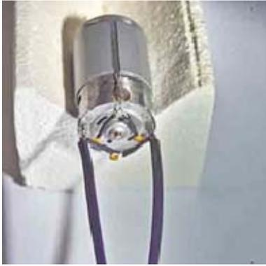
Nun kann der Antriebsmotor am Motorträger angeschraubt werden.
