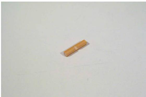
Die Abstützung des Stevenrohrs aus Leiste 219 anfertigen. Hierzu in die Mitte der Leiste schräg mit der Rundfeile eine Kerbe anbringen. Nun die Leiste als Abstützung unter dem Stevenrohr in den Rumpf einkleben.
