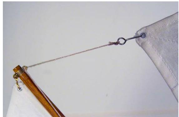
Den Holzblock Teil 227 anbringen und die Schot durch den Block führen und am Mastfuß an der Nagelbank belegen.
