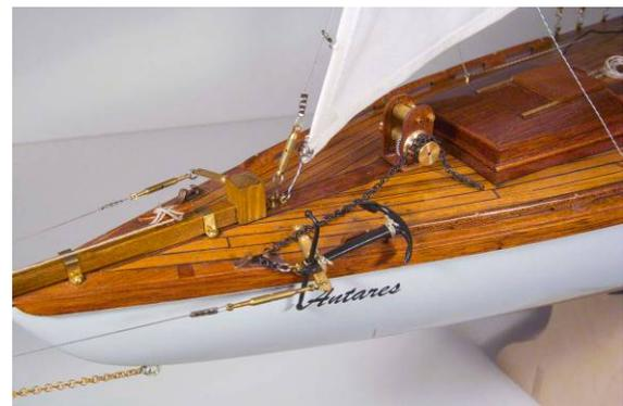
Den Anker an der Fußreling und am Bugpütting anbinden. Das Ende der Kette kann unter Deck geführt werden oder mit einem aufgeschossenen Tau verlängert werden.
