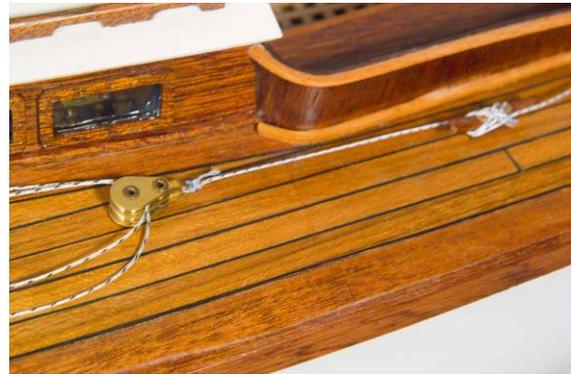
Vom Block führen wir die Schoten wieder zurück durch die freien Augbolzen bis zu den Holepunkten und zum Segel. Hier in die Schoten wieder Stagreiter zum Einhängen am Segel einbinden.
