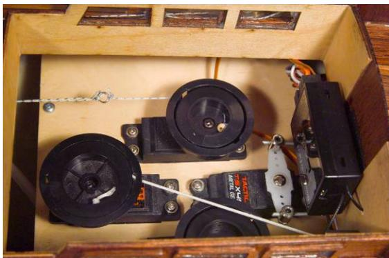
In den Ruderarm des Servos zwei Gestängeanschlüsse 206 einschrauben und die Rudergestänge 208 befestigen.
