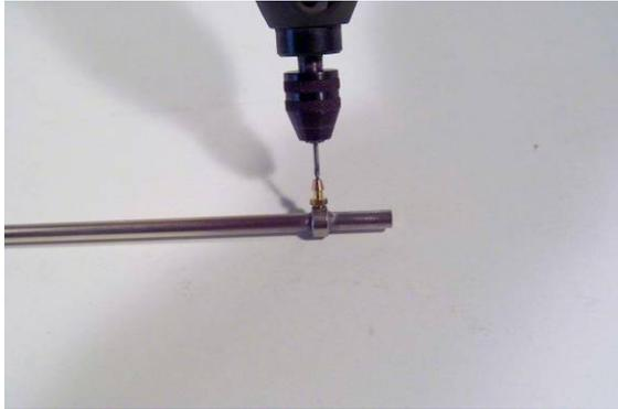
Nutzen Sie nun die Führung des Schmiernipfels und bohren durch das Stevenrohr.
