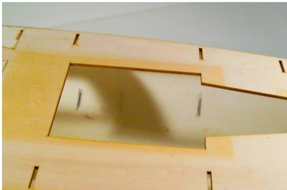
Klammern Sie nun die Auflageleisten 38 und 39 an das Servobrett und richten es 5 cm unter den Auflageleisten aus.
