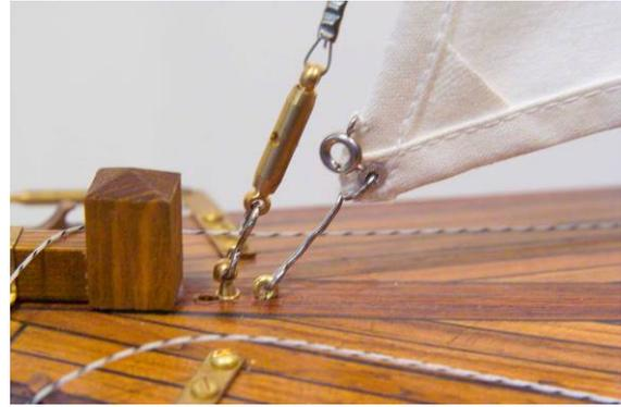
Am Hals der Fock einen Haken einsetzen und die Fock in einer Ösenschraube neben dem Fockstag einhängen. Der Haken kann aus dem Messingdraht 196 gebogen werden
