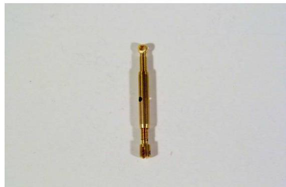
Dann die Wantenspanner an die Püttingeisen schrauben. Schraube und Mutter 216.
