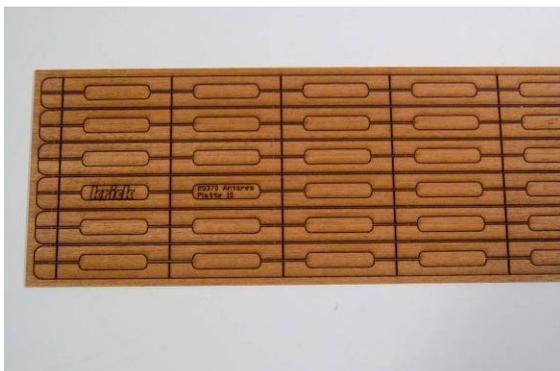
Die Teile 107 aus dem Laserbrett trennen und paarweise so zusammen kleben, dass die Markierungen für die Bohrungen innen liegen. Nach dem Aushärten des Klebers an den oben sichtbaren Markierungen 1,5 mm Löcher bohren. Dann können die Fußrelings sauber verschliffen und gerundet werden.
