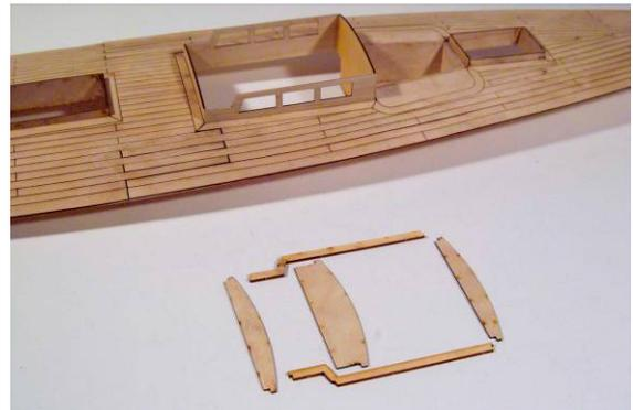
Innen den Rand des Aufbaus mit Tesafilm abkleben. Dann die beiden Dachrahmen 55 an die Aufbauseiten klammern.
