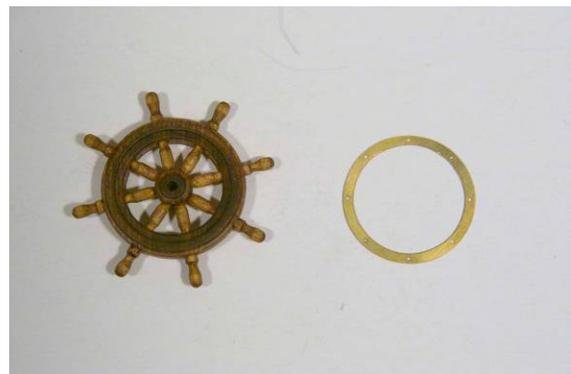
Den Messingring aus der Ätzplatte trennen und die Rückseite auf Schleifpapier abziehen. Dann mit Sekundenkleber auf dem Steuerrad anheften. Nun die Bohrungen 0,7 mm für die Messingnägeln bohren und diese einsetzen.
