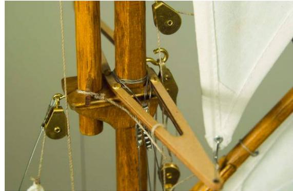
Durch die Saling rechts und links nach unten zu den Wantenspannern ziehen.
