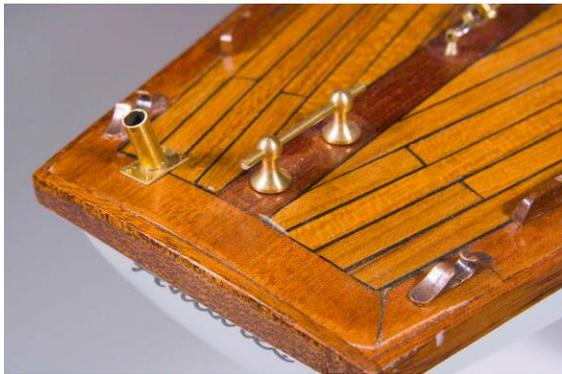
Den Sockel des Flaggenstockes am Heck anbringen. An den Ecken 4 Nägel setzen.
