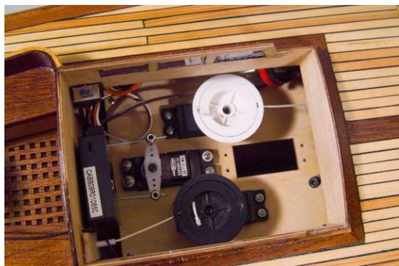
Die Winde in die vordere, mittlere Öffnung (Variante II) und in die seitliche Position (Variante I) im Servobrett einschrauben.
