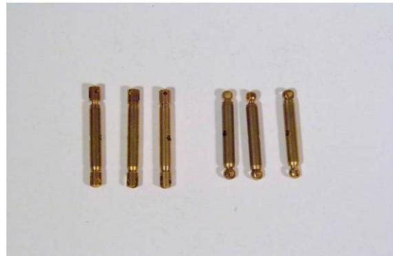
Die Spanner so umbauen, dass auf einer Seite eine Augenschraube mit Bohrung und auf der anderen Seite eine Augenschraube mit Schlitz ist.
