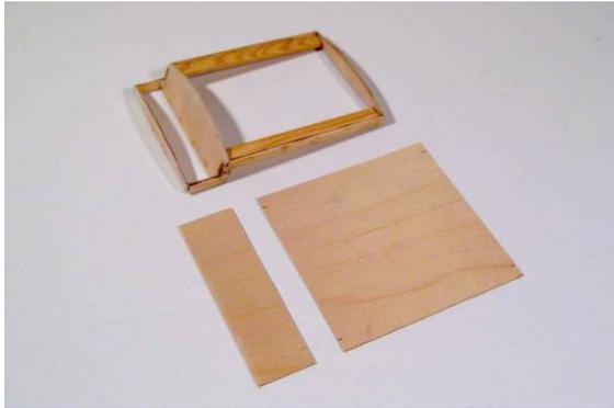
Die Dachflächen haben Übermaß und können so im Überstand an den Aufbau angepasst werden.
