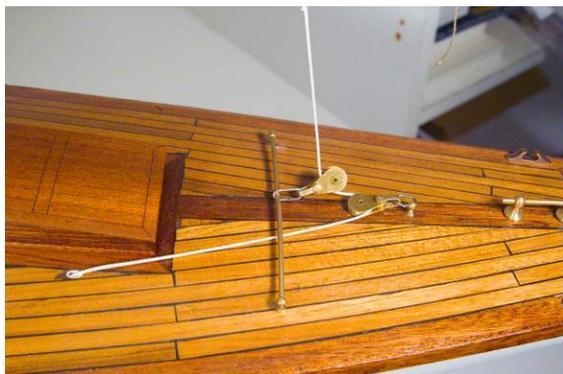
Die Schotleine Pos. 171 durch die Decksdurchführung fädeln und 2 mal um die Windentrommel wickeln. Die Winde mit der Fernsteuerung auf voll gefiert (Segel offen) stellen und die Trommel einsetzen. Jetzt die Winde dichtholen und dabei die Schot straff halten. Die Schot durch die beiden Blöcke führen und am Baum in einer Ösenschraube 167 einhängen. Dazu kann ein Stagreiter Pos. 168 an die
