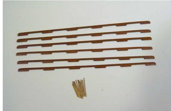
Nach dem Lackieren die Fußreling nach Plan aufs Deck setzen. 1,5 mm Messingdrahtstücke zum verstimfen einsetzen.
