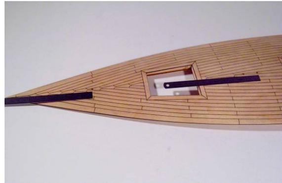
Markieren Sie die Positionen für die Decksdurchführungen so, dass die Durchführung für die Klüverschot 112 mm von der Bugspitze und für die Fockschot 25 mm vor dem Mast liegt.
