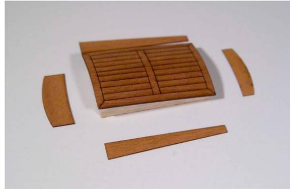
Für den Aufbau werden die Teile 79 bis 81 angeklebt.
