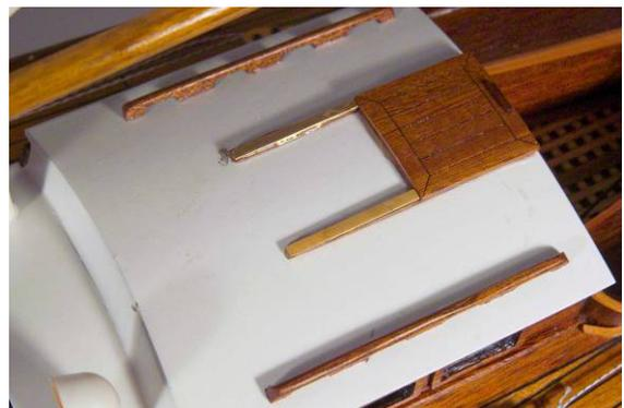
Die Laufschiene Teil 156 und 157 auf die Holzteile kleben.
