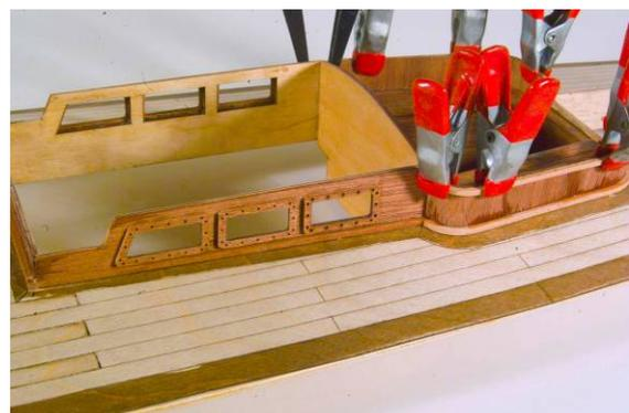
Nun die Einfassung aus Biegeleisten 116 an den Rückenlehnen oben und unten am Deck anbringen. Die Einfassung unten am Aufbau wird mit Sapellyleisten Teil 106 gemacht. Die Fensterrahmen am Aufbau sind entgegen der Abbildungen hier auf der Messing – Ätzleplatte zu finden.
