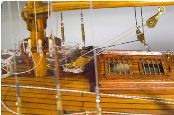
Den Niederholer aus je einem Block Teil 163 und Teil 164 anbringen. Dazu am Baum und am Fuß des Mastes je eine Ösenschraube 166 eindrehen. Damit der Mast vom Schiff demontiert werden kann, sollte der Block unten am Mastfuß mit einem Haken eingehängt werden.
