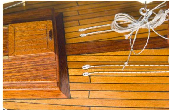
Auf Deck werden die Schoten durch die Augbolzen Pos. 158-1 bis zum Doppelblock Pos. 165-1. Dieser Block wird an einer Klampe variabel befestigt.
