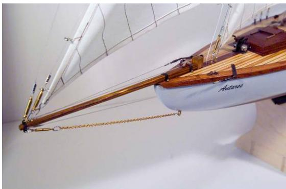
Zum Aufstellen des Mastes Als Erstes die Püttingeisen anschrauben. Das vordere Paar wird parallel zum Mast angebracht, die weiteren Positionen entnehmen Sie dem Plan.
