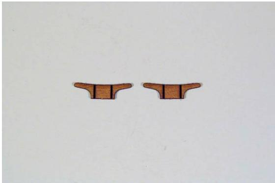
Die Teile so zusammen kleben, dass die Markierungen für die Befestigungslöcher innen liegen. Bohren Sie nun die Befestigungslöcher 1,5 mm. Durch die Lasermarkierungen erhält der Bohrer eine Führung.
