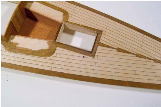
Bevor Sie nun das Deck aufkleben, behandeln Sie die Unterseite so, dass das Holz vor Wasser geschützt ist. Am besten das Deck mehrmals mit Porenfüller grundieren und dann Lackieren.
