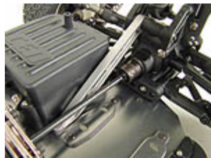
Alle Antriebswellen mit CVD-Kardangelenken
