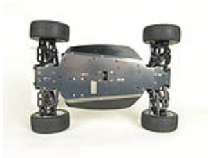
Leichtes Aluminiumchassis mit versenkten Schrauben und Ausbuchtungen für extra tief liegende Differentiale.
