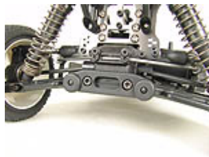
Geschlossene Halter der Querlenkerstifte an der Hinterachse. Keine E-Clips notwendig.
