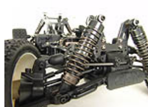
Einstellbare Aufhängung der großvolumigen Aluminiumstoßdämpfer.
