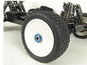
Leichte Racing-Felgen mit 17 mm Sechskant
