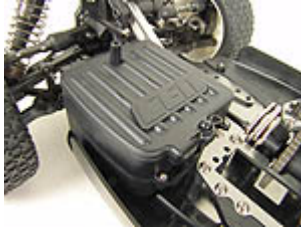
Tiefsitzende Radioplatte sorgt für einen tiefen Schwerpunkt. Großzügig dimensionierte RC-Box.
