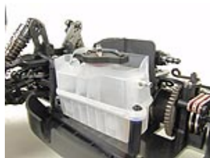
125 ml Kraftstofftank mit umlaufendem Spritzschutz und integriertem Kraftstofffilter.
