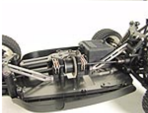
Stabile Abstützungen vom Chassis zum vorderen und hinteren Getriebeeinheit
