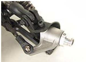
Vordere Radträger aus Aluminium
