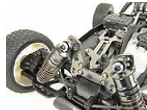
Super stabile 4mm Aluminium Shocktowers vorne und hinten
