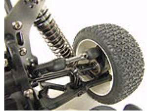
Ultra dicke Spurstangen für hohe Haltbarkeit
