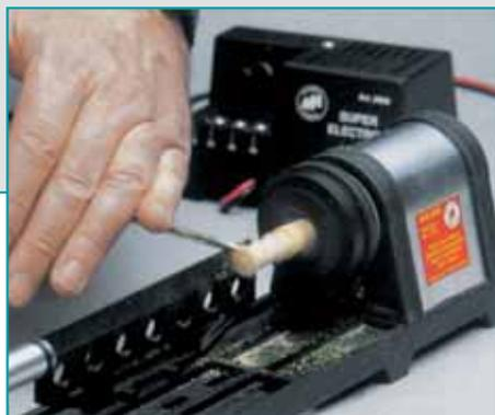
DrehSELn einer Außenkontur mit Stechbeitel.
