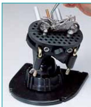
Mit dem extra Adapter kann der Werkstückhalter an der Kugelbasis des Kielhalters oder des Roto-Paint-Halters befestigt werden. Ein praktisches Mittel, das Ihnen täglich gute Dienste erweisen wird.
