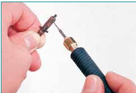
Bohren mit Bohrereinsätzen für 0 - 3 mm Bohrer
