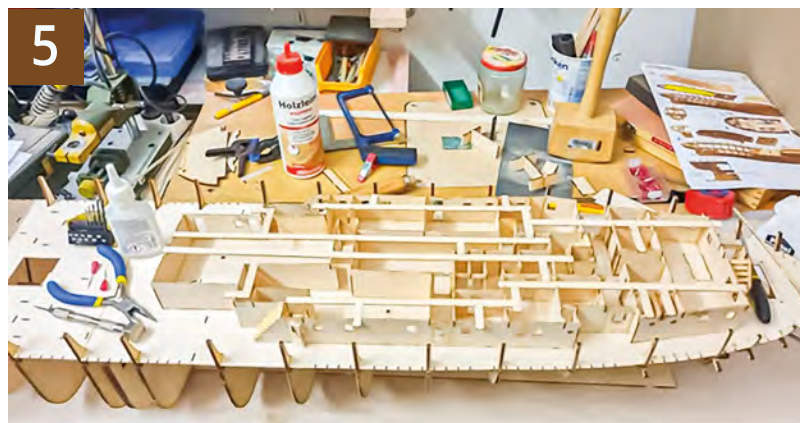
Die Holzstreifen für die Decksbeleuchtung werden schon einmal provisorisch eingepasst
