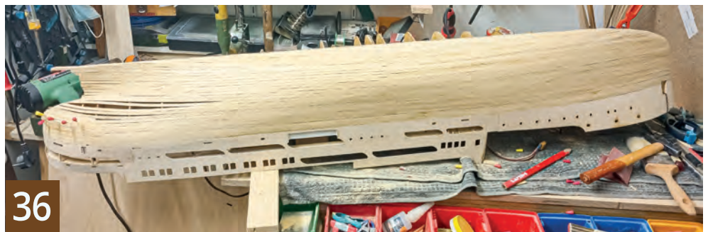
Backbord fast vollständig beplankt
