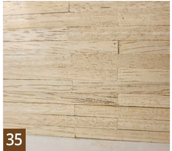
Rumpfbeplankung mit versetzten Stößen
