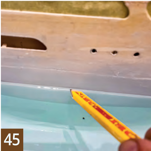
Nach dem Austrimmen wird die Wasserlinie markiert
