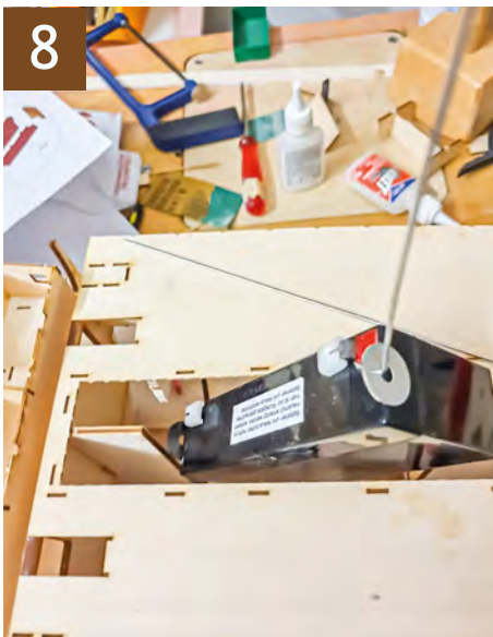
8 So werden die Akkus in den Rumpf eingefädelt
