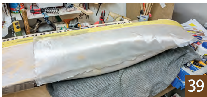
Glasfasermatten überlappend auf dem Rumpf positioniert
