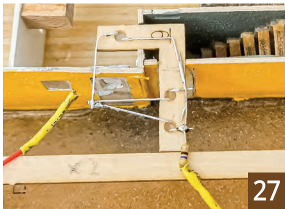
27 Drei LEDs mit eingelötetem Vorwiderstand als Einheit
