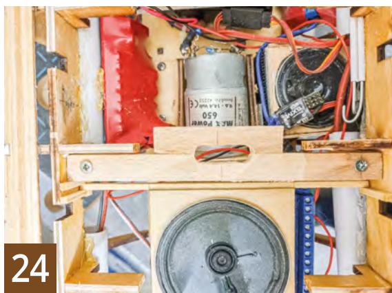
Eine Buchenholzleiste mit einem Langloch hilft bei der Positionierung und dem Verkleben des Rauchrohres
