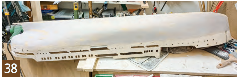
Nach dem Schleifen: glatte, laminierfertige Oberfläche
