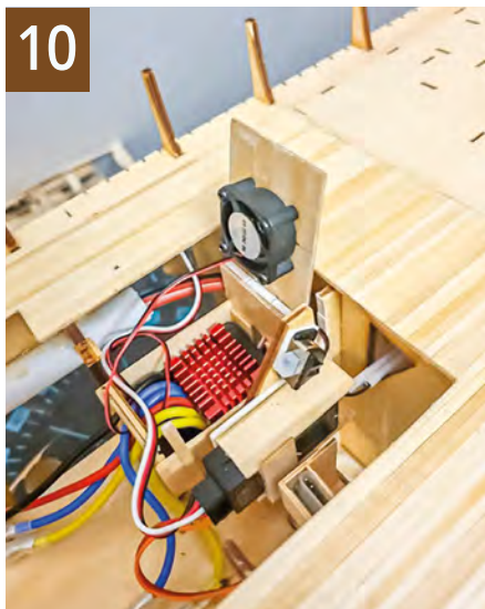
10 Regler mit Lüfter sowie der Empfänger und der Ein- und Aus-Schalter
