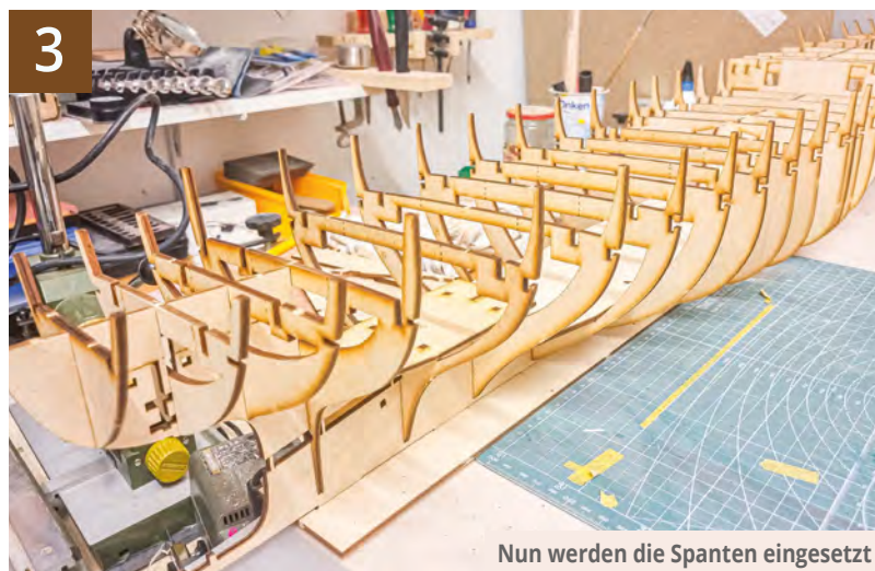
Der Kiel wird auf der Kielhalteplatte senkrecht gestellt
