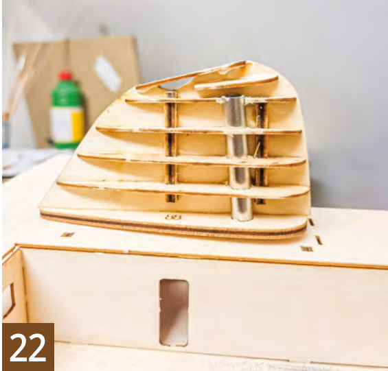
Der für den Rauchgenerator modifizierte Schornstein
