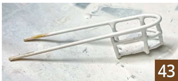
Filigran gelöteter Mastkorb aus Messingdraht
